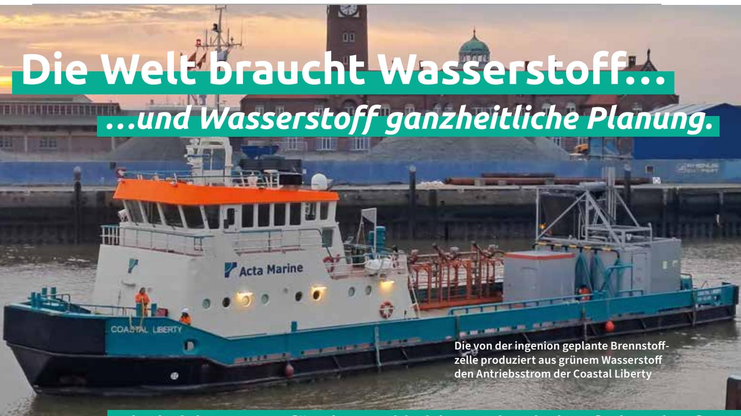
Die von der ingenion geplante Brennstoffzelle produziert aus grünem Wasserstoff den Antriebsstrom der Coastal Liberty
